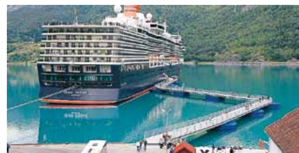
STOR FLYTBRYGGA. Den nya piren ska vara 4 till 5 meter bred och ungefär 260 meter lång. I norska Skjolden finns den här bryggan, som är ett av alternativen man tittar på. Foto: Seawalk
